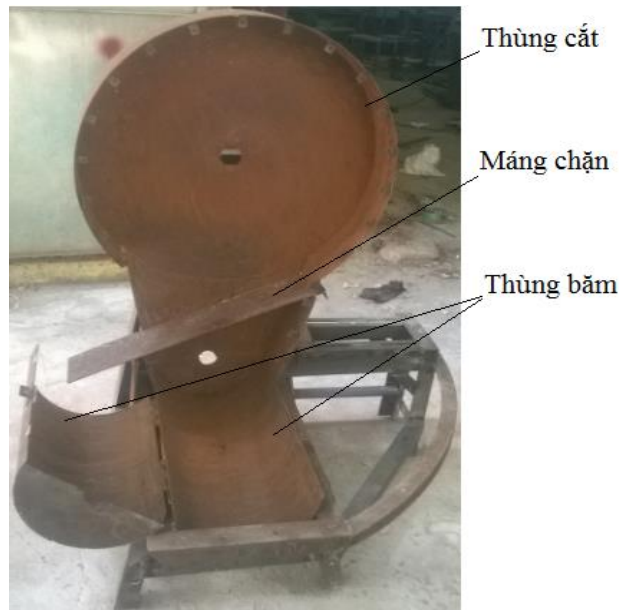
Hình 2.16 Mặt lưng và mặt đáy của máy
