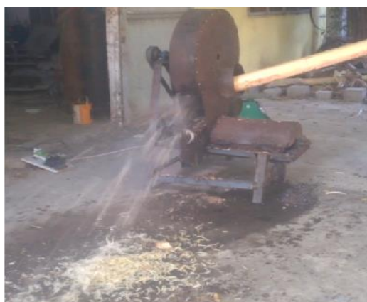
Hình 2.22 Thực nghiệm chế độ cắt không băm
