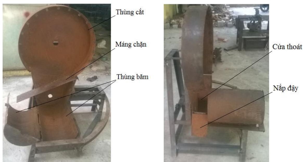
Hình 2.12 Thùng mang lưỡi dao băm
