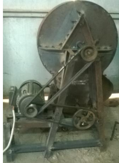
Hình 2.20 Máy cắt, băm chuối liên hợp
