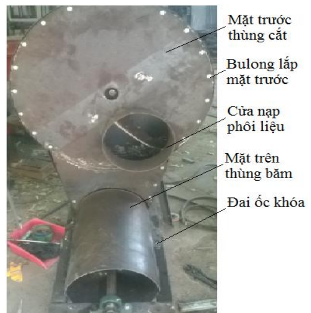
Hình 2.19 Mặt trước thùng cắt và mặt trên thùng băm
