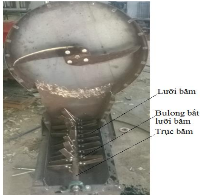
Hình 2.18 Trục và các lưỡi dao băm
