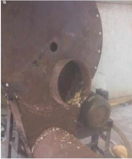
Hình 2.20 Máy cắt, băm chuối liên hợp
